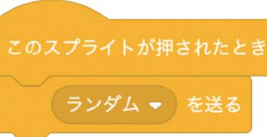
シュートをするプログラムは、サッカーボールのスプライトにあるので、新しく作ったボタンを押したら、ボールにメッセージを送るようにします。
